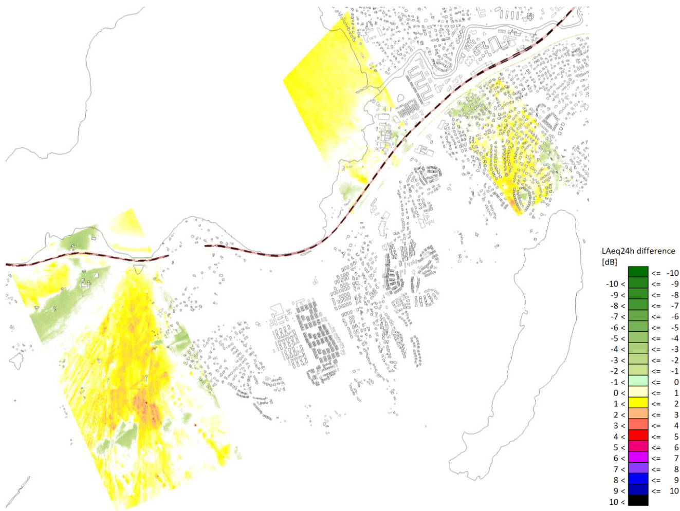
Figur 51. Skillnadsplottar ( L_{Aeq24h} ) för områdena Lerum S, M och N. Plottarna visar skillnaden mellan en beräkning gjord med Nord2000:s vanliga spårmodell, minus en beräkning gjord med Nord2000:s utbredningsmodell i kombination med en simulering av källmodellen i Nord96. Beräkningshöjd =2 m, vindhastighet 3 m/s.
