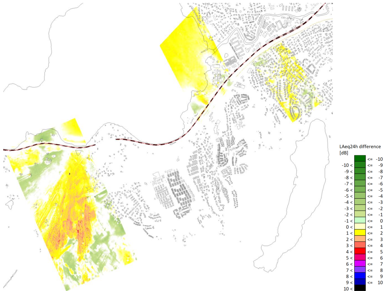
Figur 50. Skillnadsplottar ( L_{Aeq24h} ) för områdena Lerum S, M och N. Plottarna visar skillnaden mellan en beräkning gjord med Nord2000:s vanliga spårmodell, minus en beräkning gjord med Nord2000:s utbredningsmodell i kombination med en simulering av källmodellen i Nord96. Beräkningshöjd = 2 m, vindhastighet 1,5 m/s.
